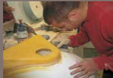
modelmaking - P.S. Oberflächen filling works
